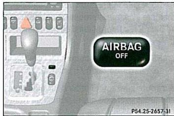
Le système de capteurs du siège du passager avant détecte automatiquement la présence d'un siège-enfant dos à la route spécial de Mercedes-Benz avec transpondeur. Dans ce cas, le voyant **AIRBAG** qui se trouve sur la console centrale s'allume. L'airbag frontal du passager est désactivé.
